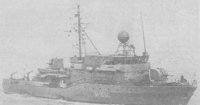
Рис. 5. Немецкий тральщик – искатель мин M1090 «Пегниц» типа «Хамельн»
